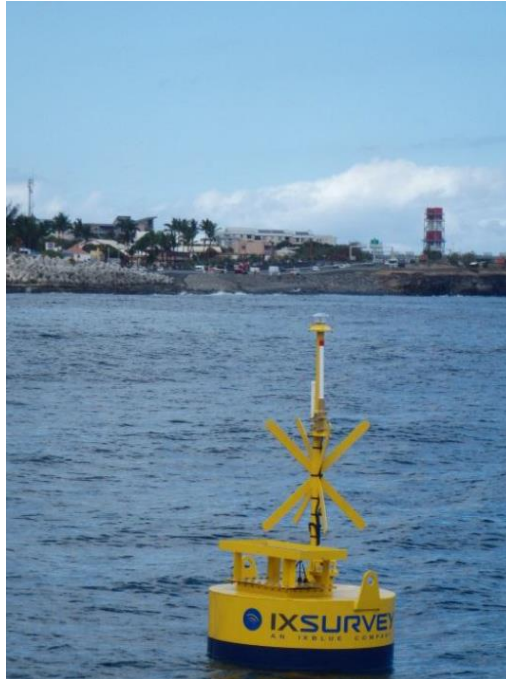
Bouée turbidimètre du Banc des Lataniers du contrôle extérieur (IX-Survey)
